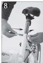
Chiudere lo sgancio rapido (Si deve sentire una certa resistenza alla chiusura dello sgancio rapido. Dovete poter leggere "close" sul lato dello sgancio rapido)
